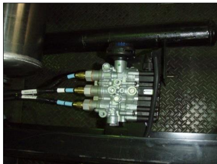
エア配管・バルブ
