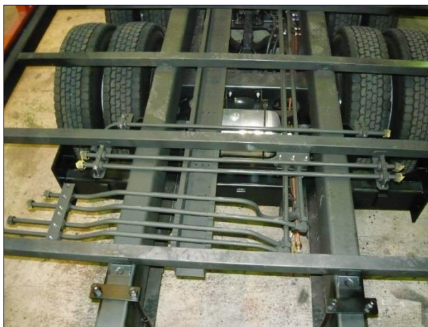
油圧配管の配索
