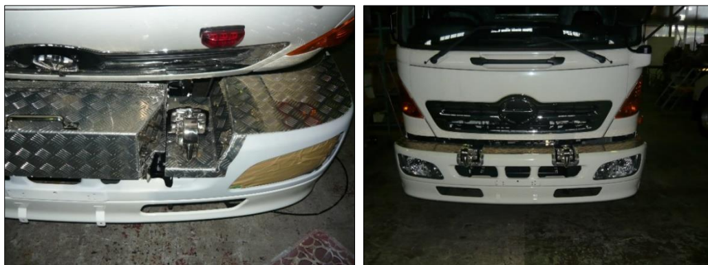
ウィンチカバー、ピンドルフック取り付け
