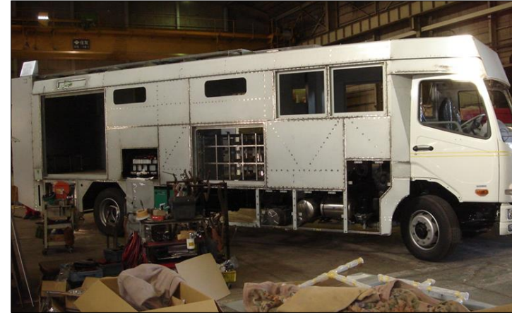
外板張り付け
