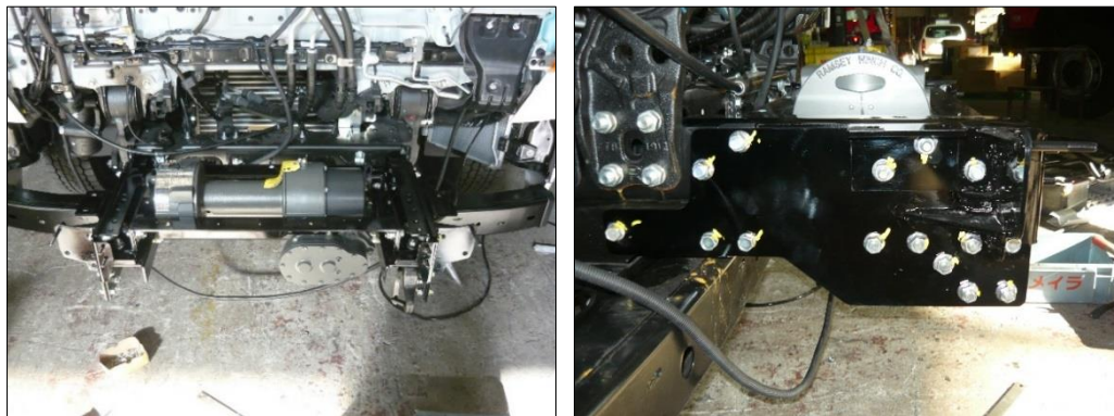
ウィンチカバー、ピンドルフック取り付け
