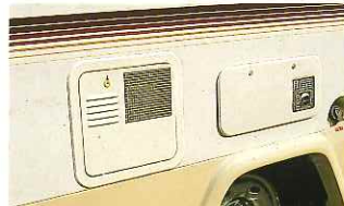
●湯沸器(オプション)&クリーンヒーター吸排気口。
