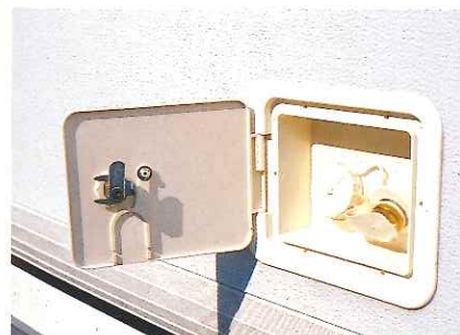
■給水口&ホース注水及び水道直結式
