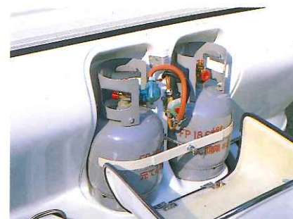
■確実に収納された5kgLPボンベ2本
