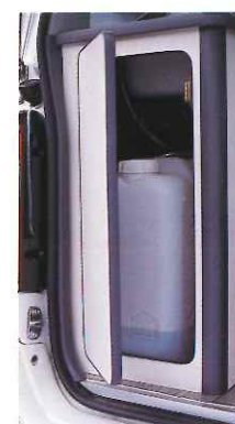
■給排水タンク
