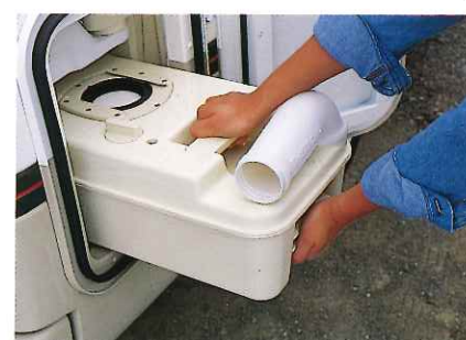
●カセットトイレ。(外部タンク)
