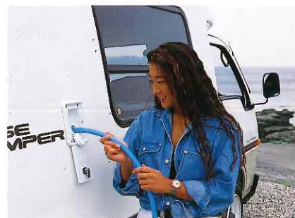
●清水タンク給水口。
