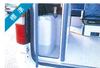
標準 給排水タンク
