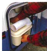
外部汚物タンク
