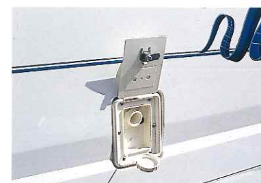
清水タンク給水口
