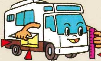
多くの装備を搭載したキャンピングカーは後荷重になりがちですが、できる限り重量物を前方に設置し、前後軸の重量配分を51:49(標準的オプション装着車の平均)としました。給水タンクも前後軸のほぼ中央に設置し、満水でも空でも重量配分が変わらないよう配慮されています。そのバランスの良さが直進安定性を生み出しているのです。
