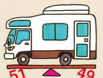
床面地上高をより低くし、収納部となるべく低い位置に設置するなど、細心の工夫をこらして低重心で安定した車体バランスを実現。インデペンデント・サスペンションとともに走行安定性を高め、より安心なドライビングを可能にしました。
