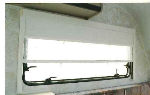
■ フライスクリーン&ローラーシェード付 二重アクリルウィンドウ
