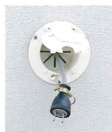
■ACケーブルハッチ
