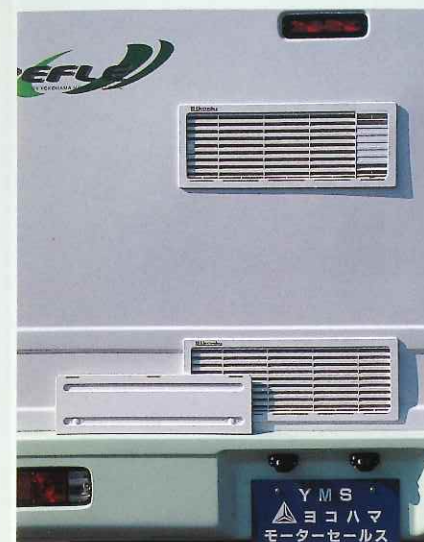
8 冷蔵庫ルーバー 冷蔵庫の通気口です。冷蔵庫を使用するときは、カバーを外します。
