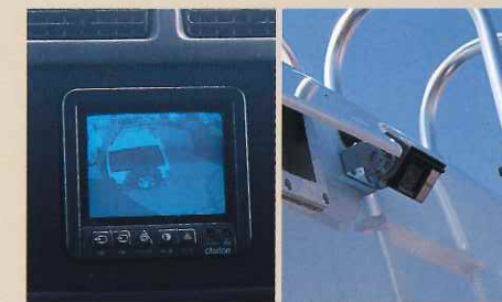
2 バックアイカメラ&モニター モニターはインダッシュタイプです。ドライバー一人での後進時に役立ちます。
