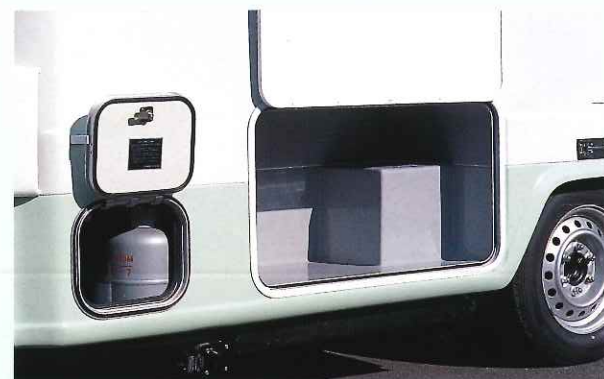
3 バッテリー、LPG点検口 バッテリーの点検やLPボンベのバルブの開閉が車外からも行えます。 4 左ストレージボックス 荷物の出し入れに便利なドアキャッチ付の収納ボックスです。
