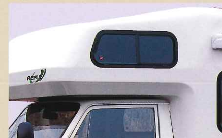
4 バンクベッドサイドウィンドウ バンクベッド両サイドに装着する網戸付ウィンドウ。室内にはカーテンを取り付けます。
