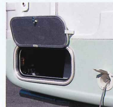
11 リヤ床下長尺物収納庫 長尺物が収納できます。 (4WD車：1800mm、2WD車：1300mm)
