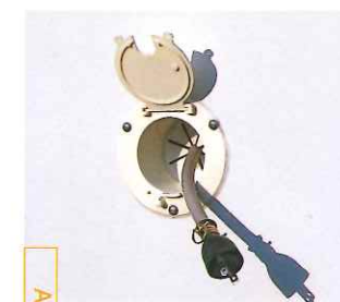
AC100V input cable AC100V入力ケーブル 外部からAC100Vの供給を受けると3ウェイ冷蔵庫を100Vに切り換え作動させることや車内のACコンセントで家庭用の100V電気器具も使えます。又、自動的にサブバッテリーの充電も開始します。
