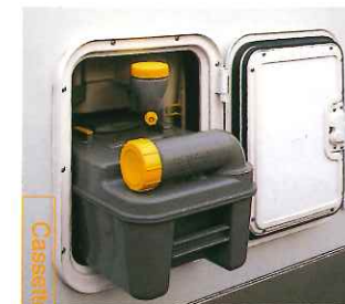
Cassette toilet tank カセットトイレタンク 外部から汚物タンクだけ取り出し一般の水洗トイレに処理できます。
