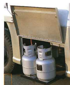
LP refill 5kgLPボンベ (2本) ガスヒーターやコンロ等キャンピングに欠かせない装備にエネルギーを供給します。スライドアウト式でメインテナンスが容易です。
