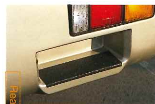
リアーバンパー ステップ 広いステップ面にはノンスリップ処理がしてあり、昇り降りが安心です。
