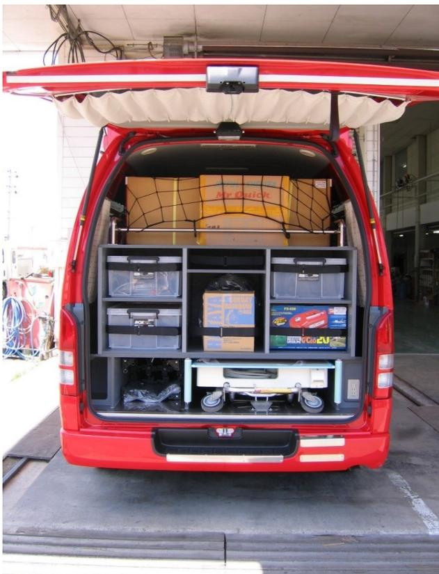
資器材を効率的に収納できるよう棚板の高さを任意に変えられます。
