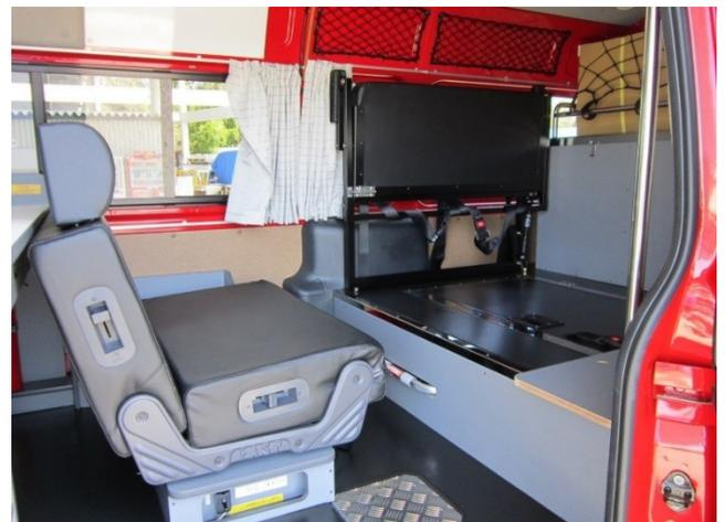
乗車シートを後ろ向きに変えられ、後の折り畳みシートを展開すれば打合せにも使用できます。
