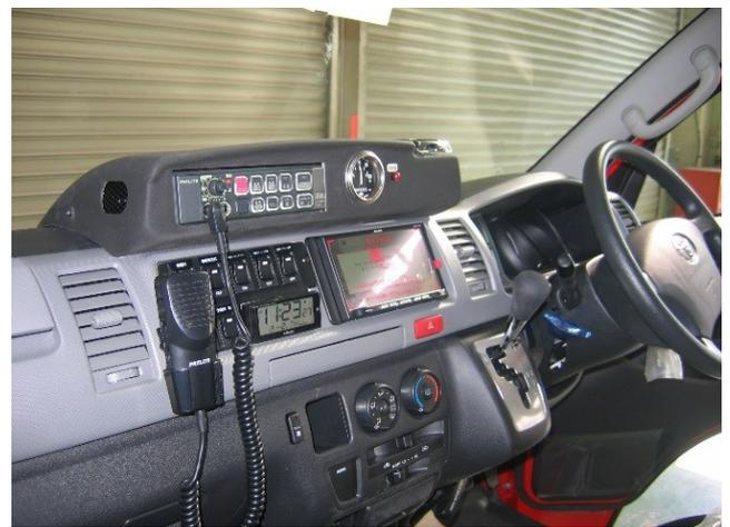
ダッシュボードに「サイレンアンプ」、「電流計」、「作業灯スイッチ類」、「カーナビゲーション・ETC」が集中的にレイアウトされており視認性、操作性に優れています。
