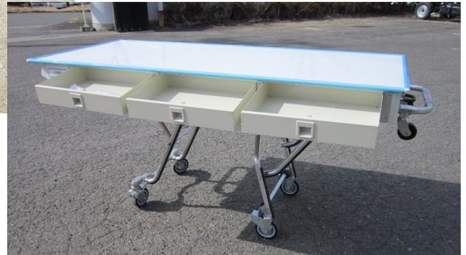
ストレッチャーを改造した移動式指揮機は、天板はホワイトボード(800mm×1800mm)になっており下側にA3用紙が入る引出を6個備え、畳むと天板の高さが275mmと非常に低くなります。
