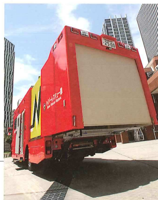
要救助者の服衣(乾的除染)スペース。引き出した屋根と壁に、テールゲート昇降装置の床とローラーテンの目隠しで作る。汚染の90%は脱衣によって除染可能。
