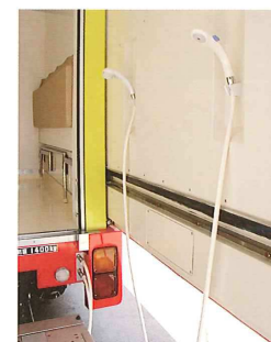
拡張部では水的除染も可能。テールゲート昇降装置の下に水槽を用意して汚染水の回収も容易だ。
