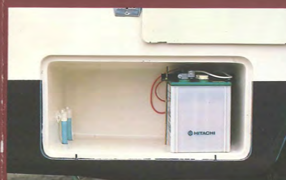
サブバッテリー収納ボックス
