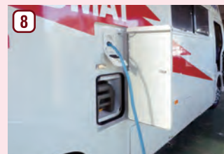
トイレカセットタンク取り出し口 専用の防臭剤を使い、手を汚すことなく下水道や水洗トイレに処理することができます。
