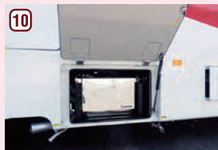
発電機収納庫 車載専用2.3kWガソリンエンジン発電機。燃料消費率：1.2ℓ／1時間（最大発電時）
