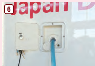
給水タンク給水口 54ℓ給水タンク。標準装備のウォーターヒーターと合わせて76ℓの水が確保できます。
