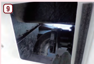
排水タンクドレインバルブ 130ℓ排水タンク。長期滞在時は専用の排水ホースを接続し離れた場所に排水できます。
