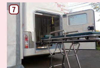
⑦ ストレッチャー搬入口
