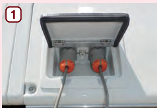
外部AC入力BOX（マグネット式） 空調用、機器用の2系統に分けて入力できます。中央に出力コンセントを設けています。
