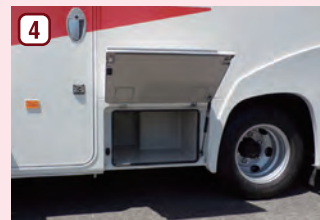
外部収納庫 ドア全開時保持装置付き。両手で積み卸しの作業が出来ます。
