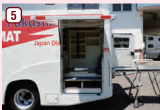
左大型ドア 開口スペース。リヤフレームがドロップダウンしているので現地での機動力となるバイクや自転車を搭載できます。
