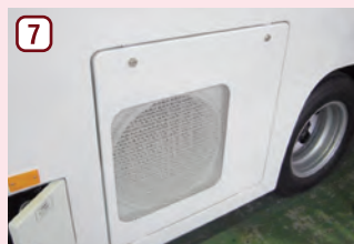
エアコン室外機 ボディにビルトインされたエアコン室外機。温風が室内に入らないよう配慮されています。
