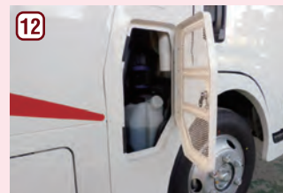
エンジン排熱口 エンジン排熱のほか、エアクリナーやリザーブタンクのメンテナンス扉としても機能。
