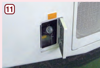
発電機燃料給油口 発電機専用の34Lガソリンタンク。
