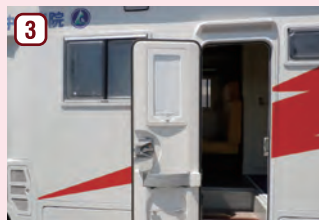
エントランスドア（シェード付き） 運転席連動集中ドアロックシステム。ウインドウはアクリル2重タイプでシェード付き。
