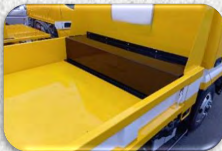
◆ 荷台容積減少加工 ※ダンプ車のみ (1ナンバー変更登録用)
