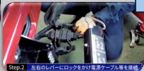
Step.2 左右のレバーにロックをかけ電源ケーブル等を接続
