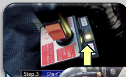
Step.3 ジョイスティックの電源を入れ、プラウ昇降レバーを操作してプラウを持ち上げ、接続状態を確認。
