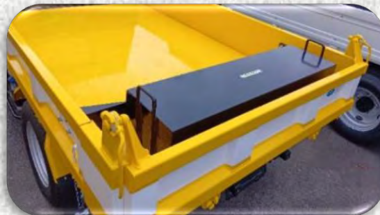
◆ カウンターウェイト取付 全軸タイヤの許容荷重内に収め、重量要件への適合を実現。作業車バランスの最適化に寄与します。
