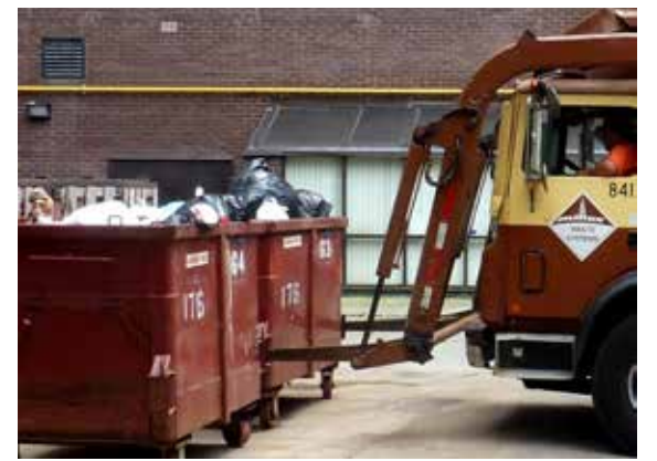
コンテナをつかんで持ち上げ、逆さにして、トラック上部に開いた穴にザッと流し込む
